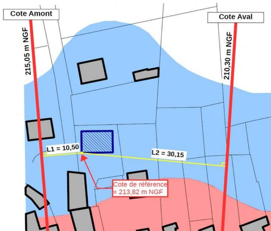
Le schéma ci-dessus définit les paramètres de la formule avec un exemple de calcul :
