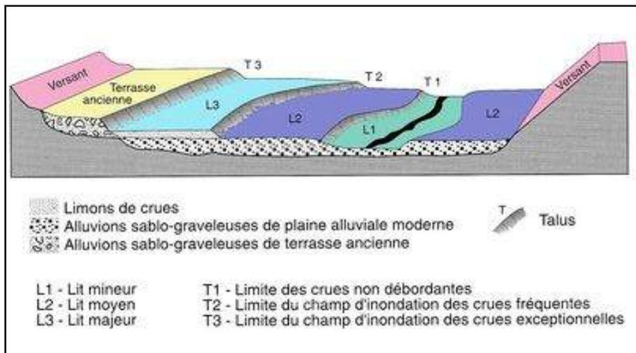
Dans un PPR, l'hydrogéomorphologie peut être utilisée pour déterminer l'aléa dans des secteurs à faibles ou peu d'enjeux et pour délimiter l'enveloppe de la crue exceptionnelle.
