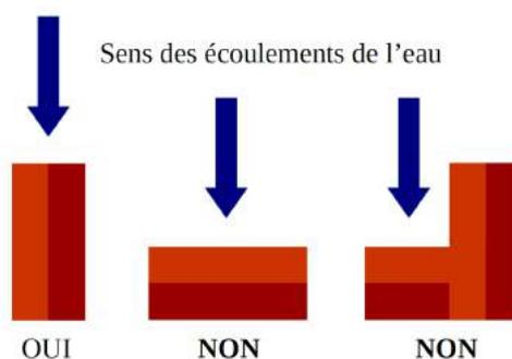
**L**e choix d'implantation d'un ensemble de constructions doit prendre en compte la nécessité de conserver une transparence hydraulique en ménageant des espaces libres pour l'écoulement. On tiendra compte du fait que le niveau de crue est rehaussé entre les bâtiments et que la vitesse du courant est augmentée dans les rétrécissements.
