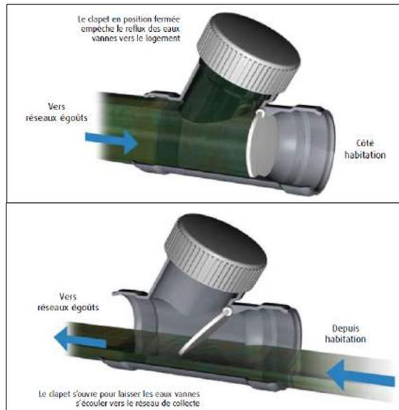
Ce clapet peut être installé facilement dans un regard existant d'eaux usées en amont du réseau. Le cas échéant, un tel regard sera à créer, avec un couvercle facilement repérable et accessible.
