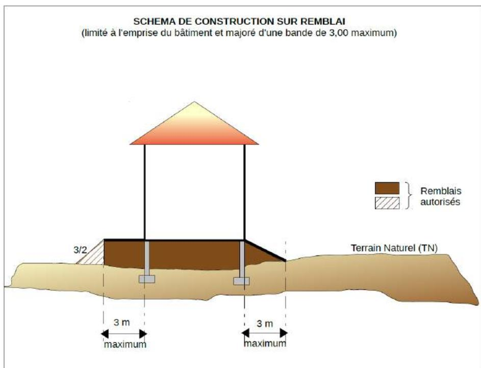
**A**fin de limiter l'effet d'obstacle, la plus grande longueur du bâtiment doit être placée dans l'axe des écoulements de l'eau. On évitera les décrochements importants au niveau de l'emprise de la construction (voir schéma de principe ci-dessous)
